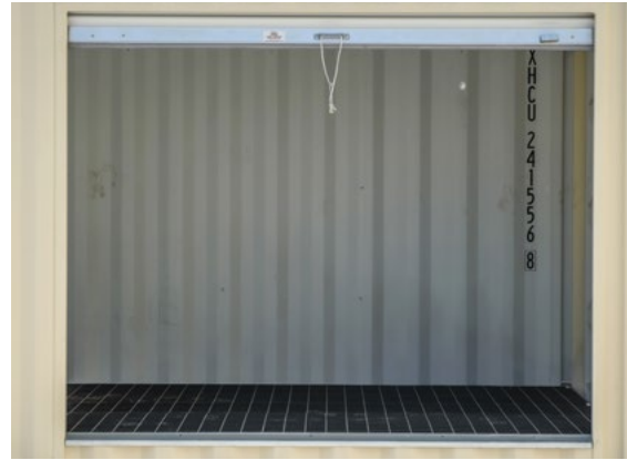
CUVE DE RÉTENTION
